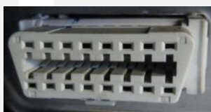
12V車両のDLC(OBD2) コネクタに接続
